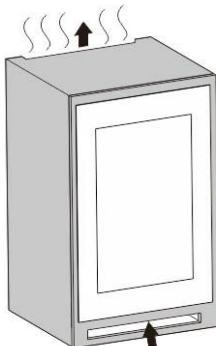
**Il modello DAUF-39.119DB.TO si ventilerà attraverso la griglia anteriore. Non copra mai la griglia del refrigeratore per vini.**
